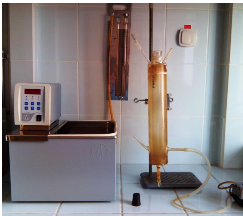
Рисунок 1.5. Продувка внутреннего объема испарительной камеры при помощи микрокомпрессора
