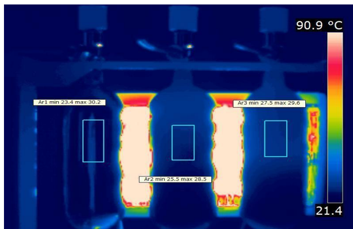
Рисунок 2.7 - Пример ошибочных измерений тепловизором
